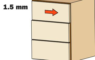
Girar la rueda blanca hacia la parte trasera del cajón para regularlo hacia la derecha.
